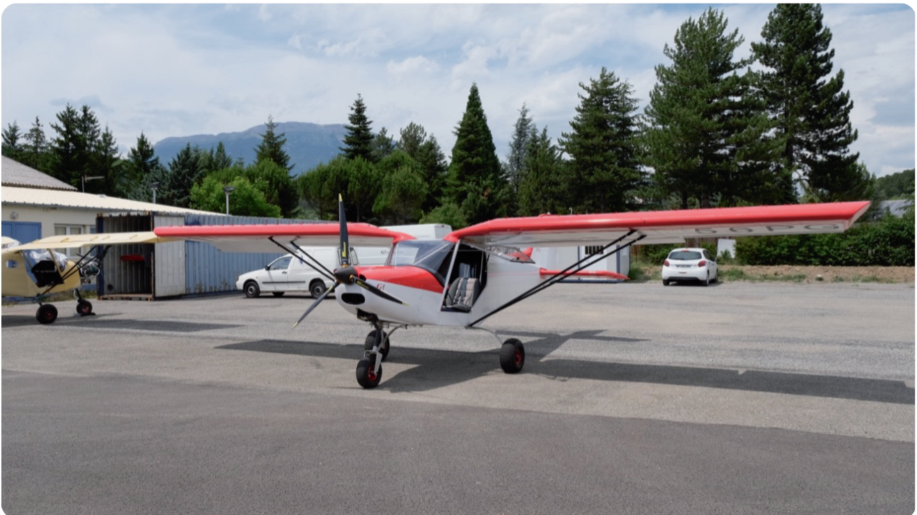
Le G1, un avion ULM (Ultra Léger Motorisé) Super STOL (Short Take-Off and Landing) adapté au vol de montagne
