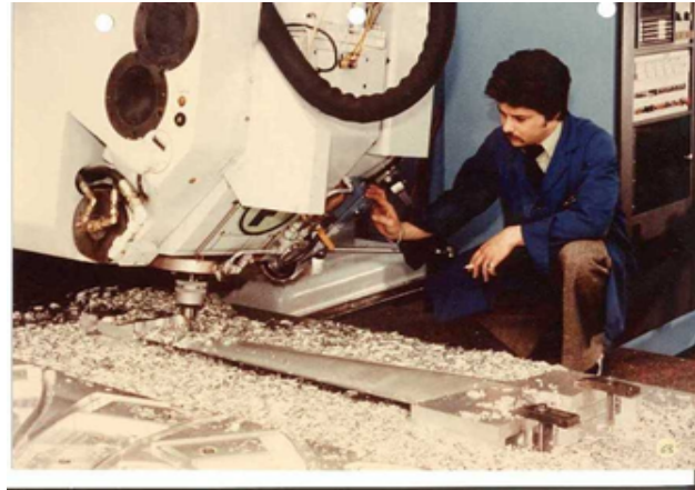
CN dans CATIA.....aile de maquette de soufflerie.....CN dans l'atelier
