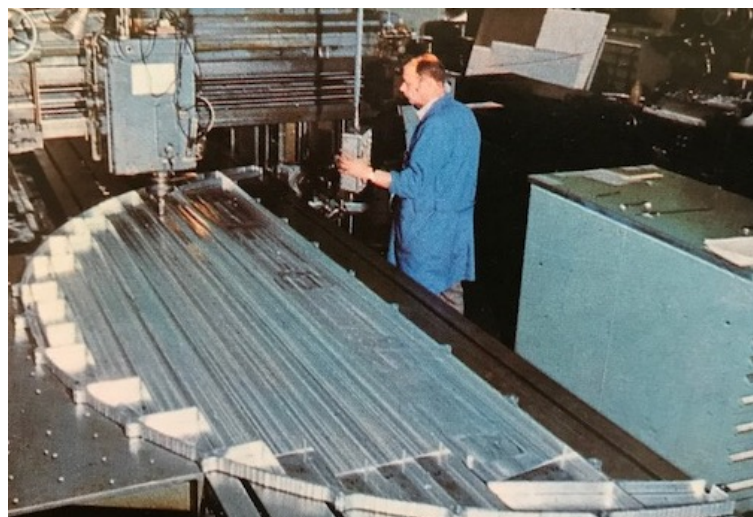
Cadre de Mercure usiné dans la masse
