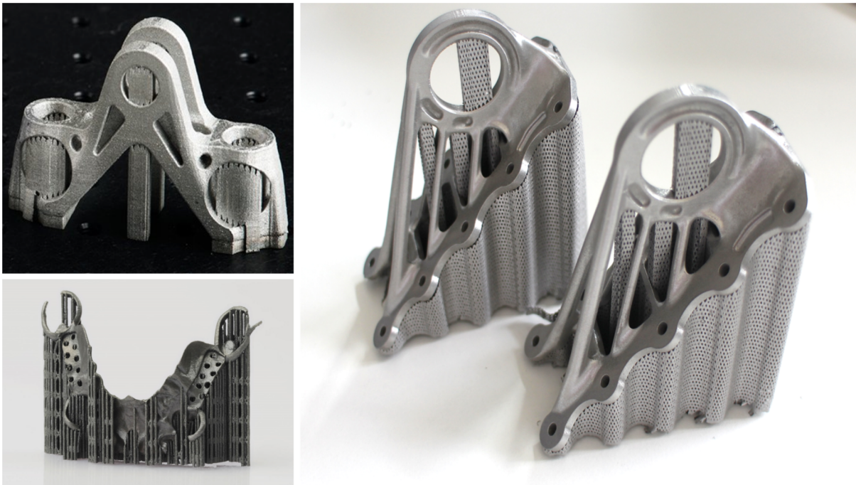
Figure 7: exemples de pièces fabriquées par fabrication additive avec des structures de support
