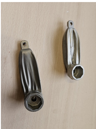
Présentation des pièces après impression. A gauche la pièce sans contrainte de surplomb, à droite la pièce avec contrainte de surplomb.
