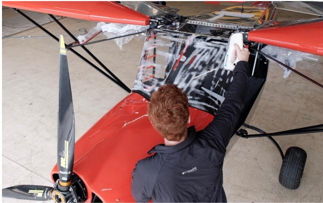
S'en est suivie une phase de « nettoyage » du scan brut, puis une phase de « rétro-conception » appelée aussi « retro-engineering » pour modéliser le pare-brise en s'appuyant sur les données de la surface de l'objet récupérée en amont.
